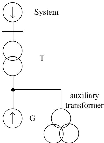
Fig. 6.8. The unit diagram
